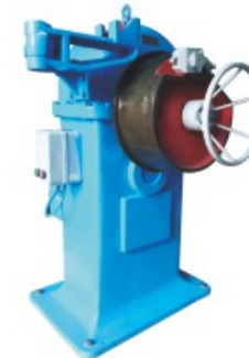
8270轧尖穿模机 Φ 2.5mm-Φ 8.0mm 8270-type pointing and die-punch machine Φ 2.5mm-Φ 8.0mm
