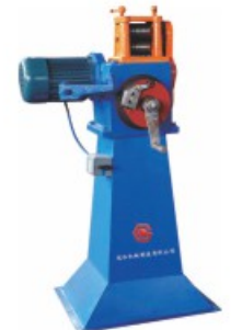
60型轧尖穿模机 Φ 1mm-Φ 3.0mm 60-type pointing and die-punch machine Φ 1mm-Φ 3.0mm
